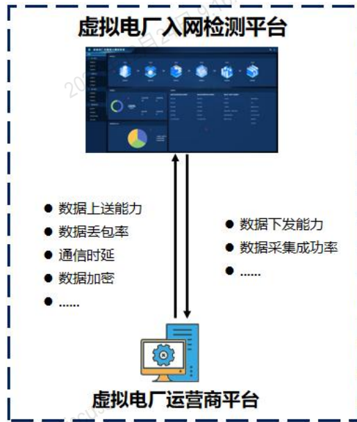
图3 运营商平台功能及网络安全现场测试布置图
